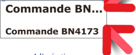
A l'exécution: En haut, avec option «ellipse»: le contenu est tronqué En bas, avec l'option «réduction»: la taille de la police a été automatiquement réduite, le contenu entier est affiché
